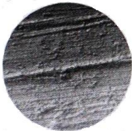
Şək. 5.7. Materialın bərkidilmiş abrazivdə yeyilməsi zamanı sürtünmə səthinin tapoqrafıyası: material- polad 3, x10
