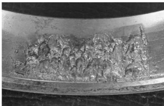
Şək. 5.24. Diyirlənmə yastığının daxili diyirlənmə səthinin adgeziya yeyilməsi (material – polad ŞX15, x4)
