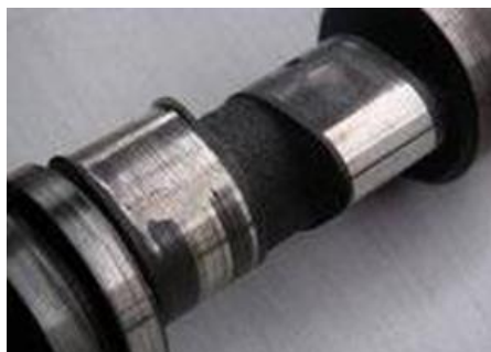
Şək. 1.2. KamAZ 740 mühərrikinin qazpaylayıcı mexanizminin paylayıcı valının abraziv yeyilməsi (material pol.45)
