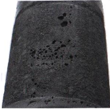
Şək. 5.21. DYM-nin silindrinin köynəklərarası fəzasının kavitasiya yeyilməsi (mat. - çuqun CЧ30).
