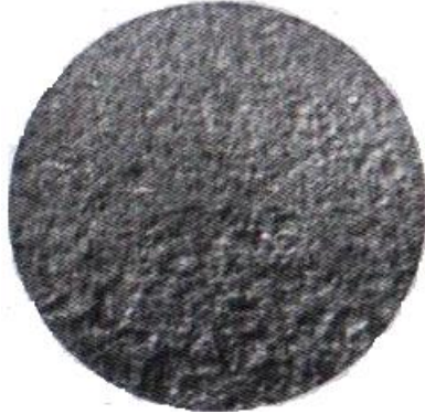
Şək. 5.13. Bərkidilmiş abrazivə (material – polad 3, \times 10 ) zərbə zamanı yeyilmiş metal səthin topoqrafiyası.
