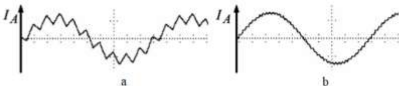
Şək. 5.34. asinxron mühərrikin statorunun cərəyanlarının EİM modulyatorunun dayaq gərginliyinin aşağı (a) və yuxarı (b) aparıcı tezliklərində ossilloqramları
