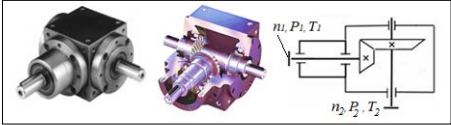
Şəkil 1.1.4. Birpilləli konusvari dişli çarx reduktoru
