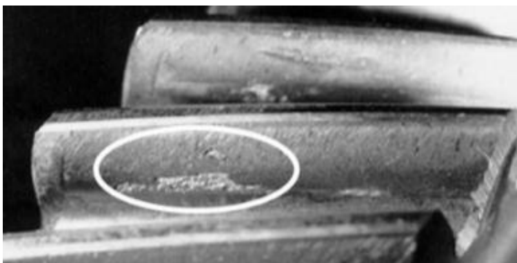
Şəkil 2.2.2. Dişlərin pitting (işçi səthlərin ovxalanması) nəticəsində sıradan çıxması
